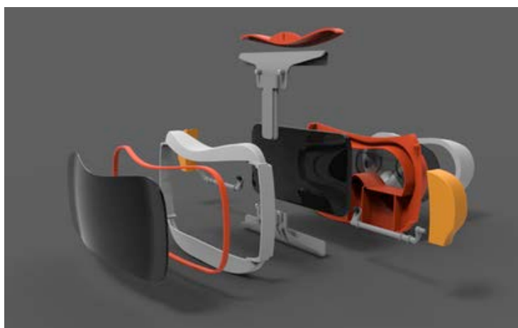
Figura 4 – visão explodida do produto View-Master VR
