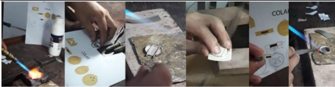
Figura 4 – Processo de Fabricação da Medalha Fonte – Autor
