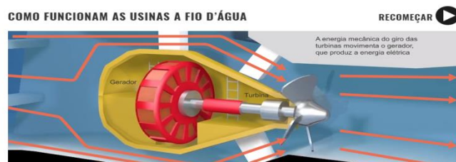
Figura 4: Funcionamento de uma usina a fio d'água
