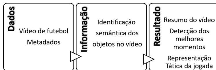
Diagrama 1 – Estrutura de um sistema de análise do vídeo destinado ao futebol.
