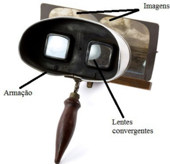
Figura 02: estereoscópio de Holmes-Bates e seu funcionamento
