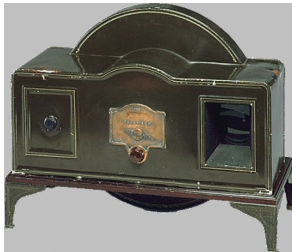
Figura 01. Aparelho televisor mecânico, década 1920, com elementos tecnológicos encerrados dentro de uma proposta mobiliária.
