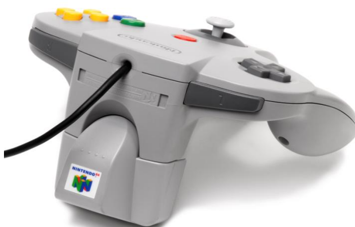
Figura 4 - Joystick Nintendo 64 com rumble pack
