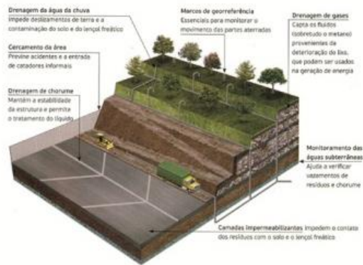
Figura 2 – Infográfico Como deve funcionar um aterro sanitário
